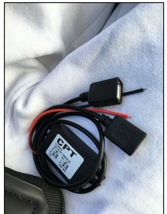
Convertisseur 12volt -> 5volt
